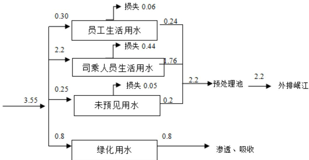
图 2-1 本项目水平衡图 单位：t/d
